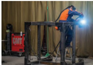
↑ Zváranie oceľových konštrukcií
